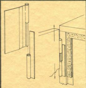
LIFT-OFF SAFE TYPE HINGE
