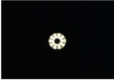
Fig. 4. Image du spot à LEDs prise à la caméra à travers deux filtres neutres (OD 3 et OD 2) à 1 m de distance.
